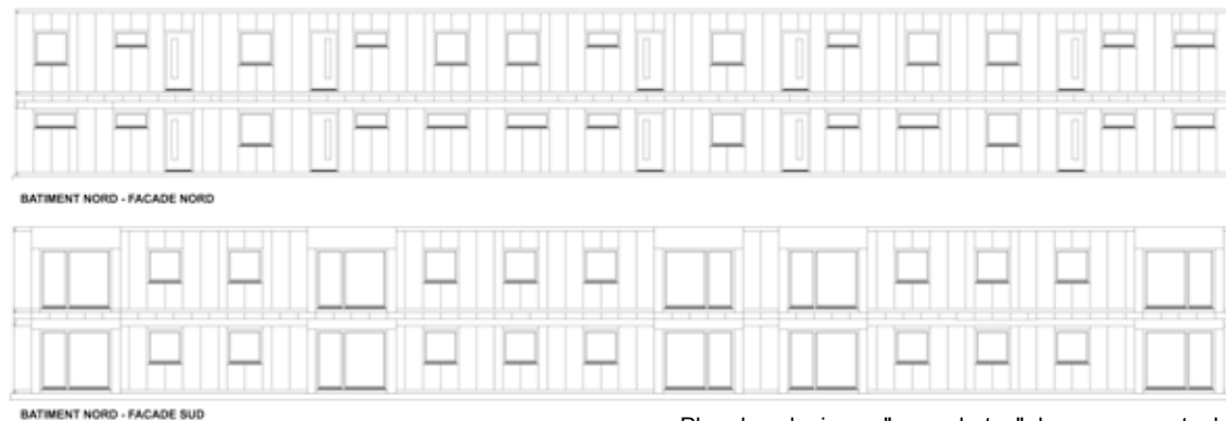
Plan de calepinage "sans chutes" des composants de façades en panneaux de bois contrecollé
